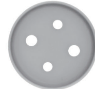
检测孔有无，孔径 外径、脏污、黑点
