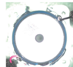
点胶产品检测点胶有无 配件有无缺失
