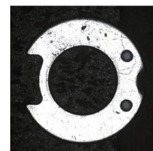
冲压零部件 检测表面压伤
