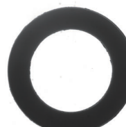
圆形产品检测内径、外径 毛刺、真圆度、同心度
