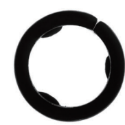
检测多料、少料 内外径、毛刺
