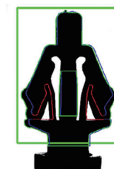
电池盖检测表面压伤 检测有无、错位
