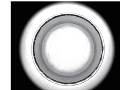
检测圆壳体 内壁不良
