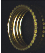
压铆螺母检测 有无螺牙
