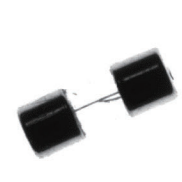
检测保险管 多丝、破孔
