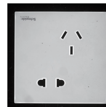
塑胶件检测 丝印不良，污点不良
